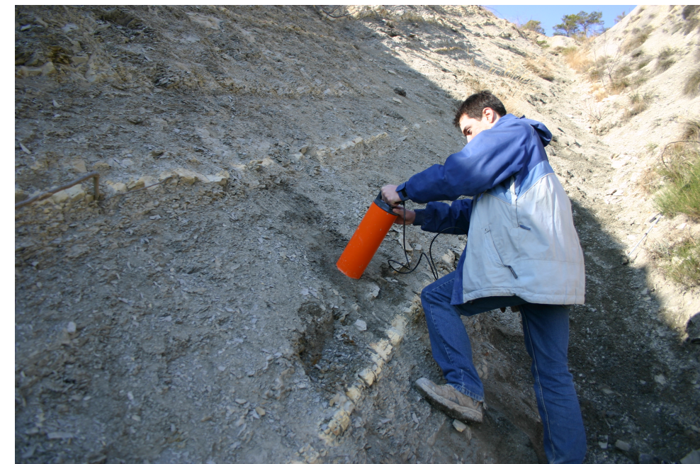
Fig. 2: Mesure d'un proxy à des fins de cyclostratigraphie, ici la radioactivité naturelle gamma.
